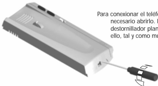
Para conectar el teléfono y fijarlo a la pared, es necesario abrirlo. Realizar levemente palanca con un destornillador plano en las ranuras dispuestas para ello, tal y como muestra el dibujo.
