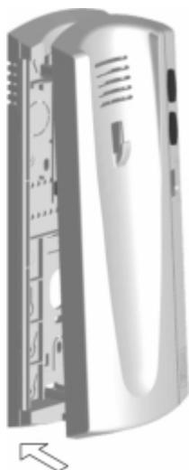
Pasar los cables por el orificio dispuesto a tal efecto, y conectarlos a la regleta según los esquemas de instalación. Cerrar el teléfono tal y como muestra el dibujo. Una vez cerrado, conectar el auricular mediante el cordón telefónico y colocarlo en la posición de colgado.
